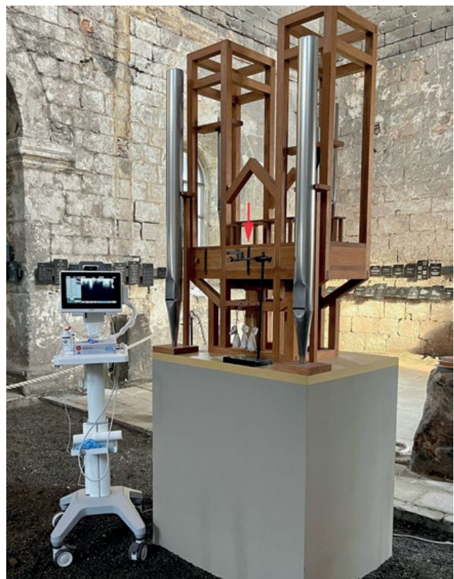
Bild 1: „InnoSight Ultraschallsystem“ neben der Orgel in der Burchardikirche in Halberstadt. Der rote Pfeil zeigt auf die mit Ultraschall untersuchte Metallstrebe an der Vorderseite der Orgel. (Foto: Dieter Kunze, Pfeiffers Garten 5, 38820 Halberstadt)
