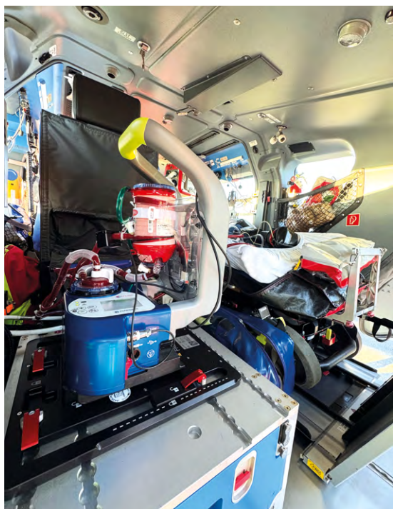
Das Colibri wird auf einer speziellen Halteplatte im Hubschrauber gesichert.
